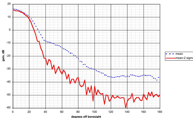
**Fig. 3-8. MGA transmit gain pattern.**
